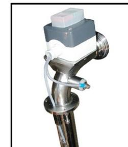
Detalle de bastón llenado-vaciado
