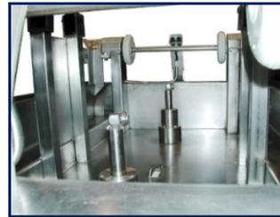
Con el modelo **EKIVINO MANUAL (1501)** el centrado de las barricas se debe realizar de forma manual, mientras que el modelo **EKIVINO AUTOMATICO (1502)** incorpora un sistema automatizado para el centrado
