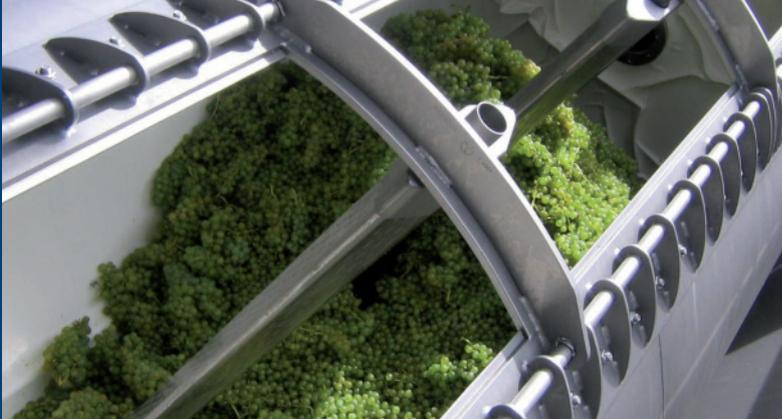
La abertura de la compuerta ocupa todo el largo del depósito. Gracias a esta gran abertura de la compuerta, puede llenar completamente la prensa desde arriba usando cajas o cintas transportadoras. El vaciado y la limpieza también se hacen rápida y cómodamente.
